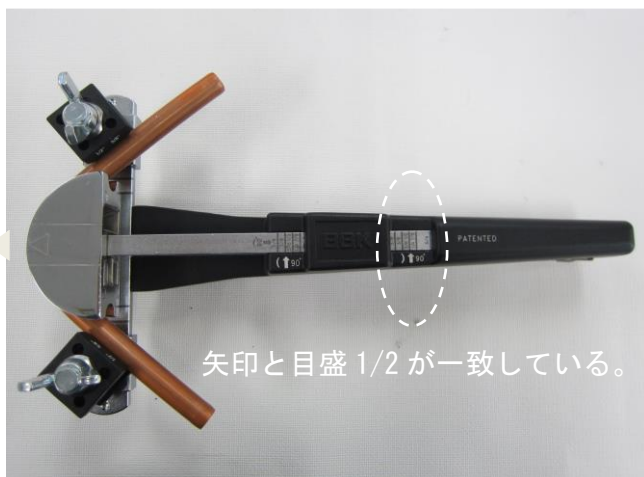
写真①:90° 正曲げ 1/2 なまし銅管曲げ例
