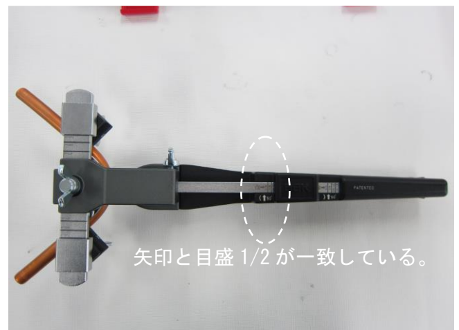
写真②:90° 逆曲げ 1/2 なまし銅管曲げ例
