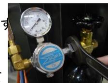
②酸素ボンベと酸素調整器はスパナを使ってしっかり締め付けます。
